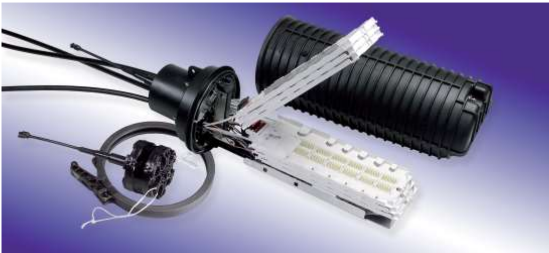
M2-1.1. ábra: gél szigetelésű kötéslezáró, 144 szálig használható.
