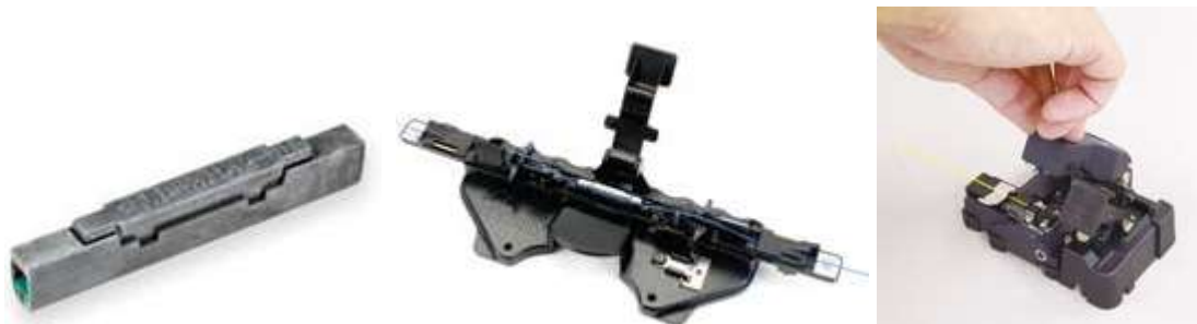
TM-6. ábra: mechanikus kötőhüvely, kötőgép és száltörő (használat közben)
