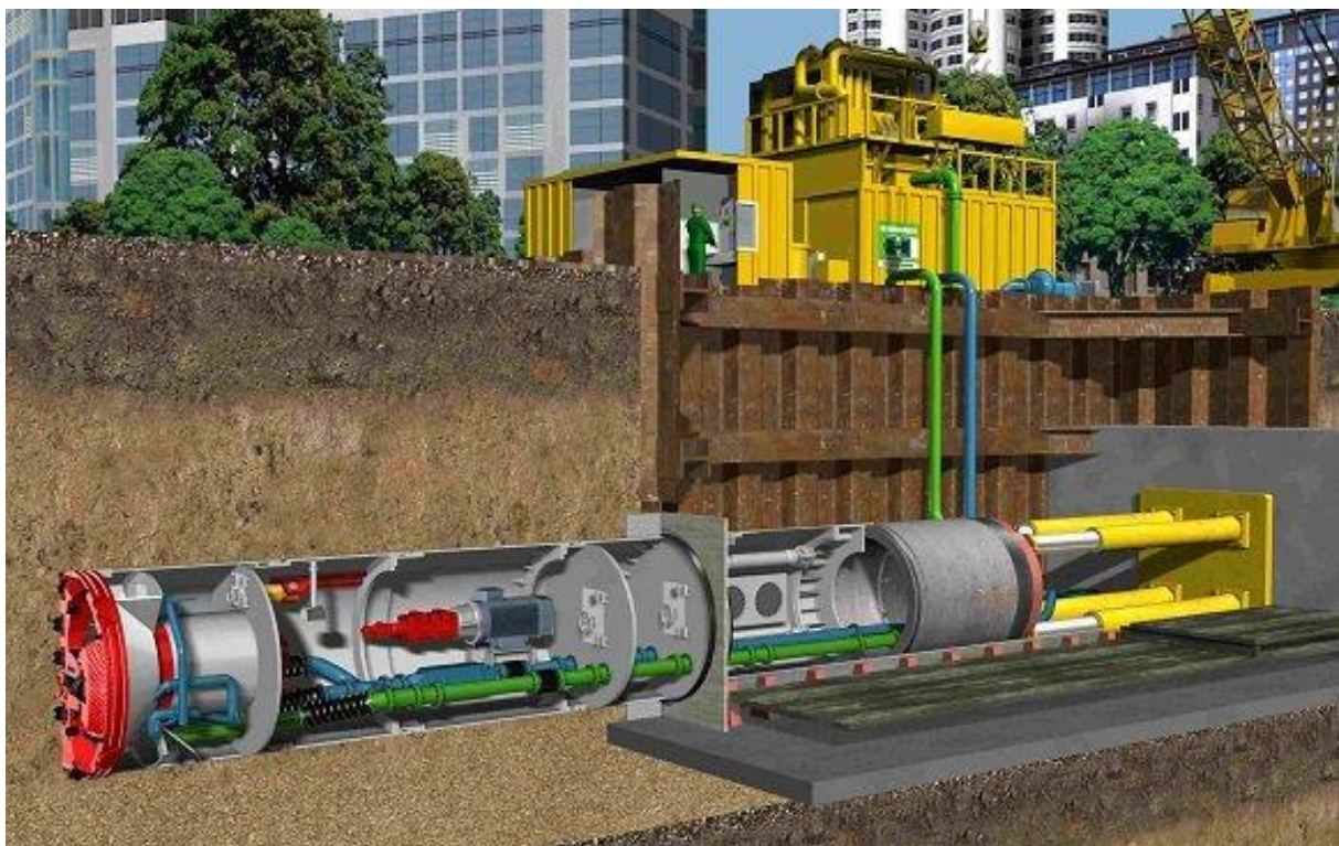
M3-3. ábra. ábra: AVN microtunneling eljárás hosszmetsete
