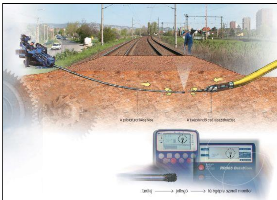
M4-1. ábra: Az irányított talajfúrási technológia vázlata
